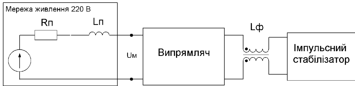
Рисунок 1. Структурна схема імпульсного джерела живлення з фільтром завад, підключеного до мережі з паразитними параметрами
