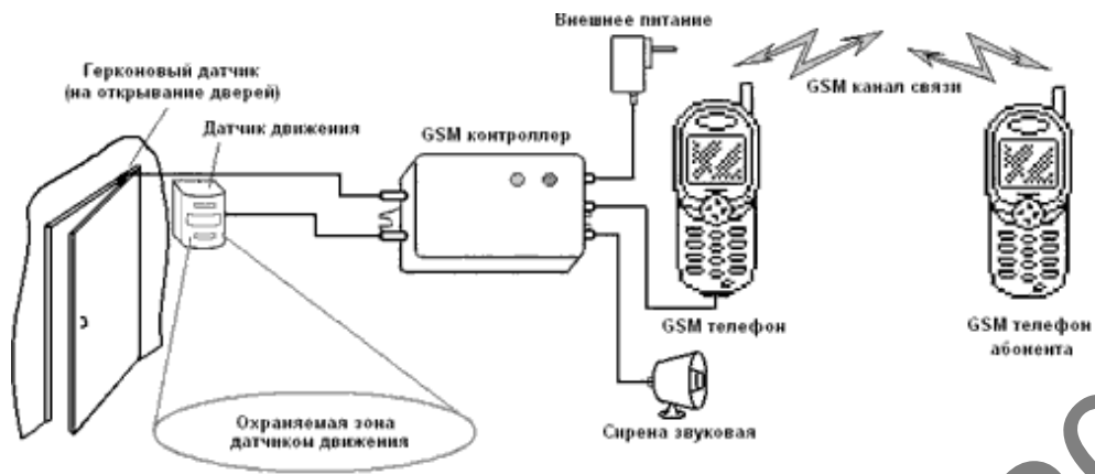
Рисунок 1.6 – Принцип дії GSM-сигналізації
