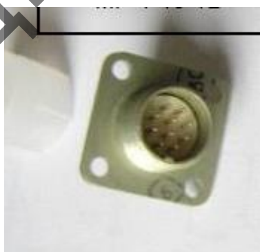
Рисунок 2.6 — Роз'єм радіо герметичний багатоконтактний всекліматичний MP1-10-1B
