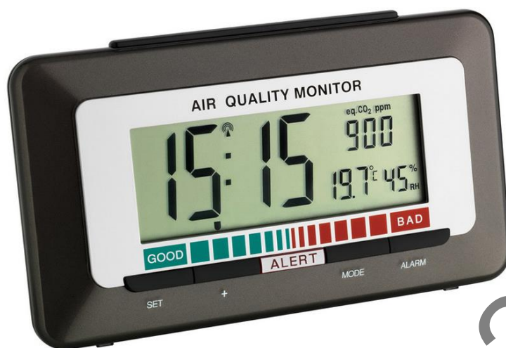
Рисунок 1.3 — Зовнішній вигляд метеостанції TFA-602527 [3]
