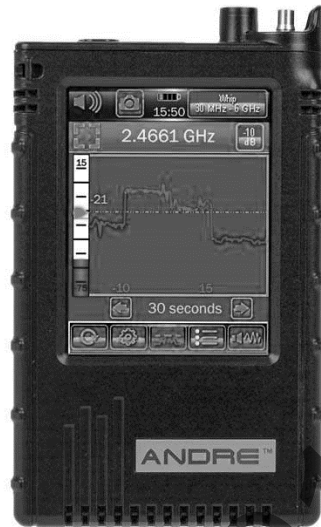
Рисунок 1.7 — Зовнішній вигляд широкосмугового детектору поля Andre
