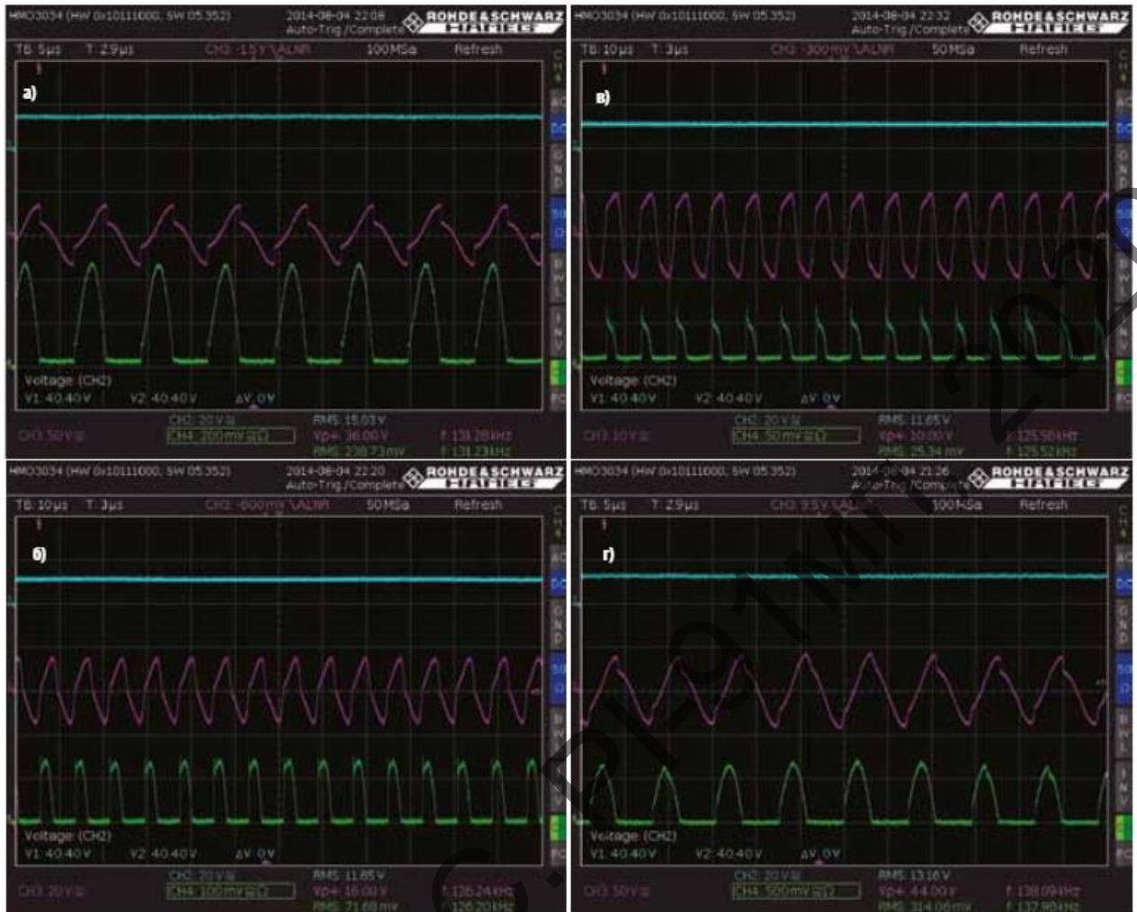
Рисунок 4.8 – Осцилограми, що описують різні умови випробувань: а) варіант 1 ( TX - WE \# 760\ 308\ 101\ 302 , L = 5,3\ \mu\text{Гн} ); б) варіант 2 TX - WE \# 760\ 308\ 104\ 113 , L = 12\ \mu\text{Гн} ); в) варіант 3 ( TX - WE \# 760\ 308\ 110 , L = 24\ \mu\text{Гн} ); г) варіант 4 ( TX - TDK \# WT-505060-8K2-LT , L = 5\ \mu\text{Гн} )
