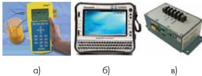
Рисунок 2.12 — Модулі зв'язку з датчиками eCup (а), FluidTrakr (б), VisConnect (в)
