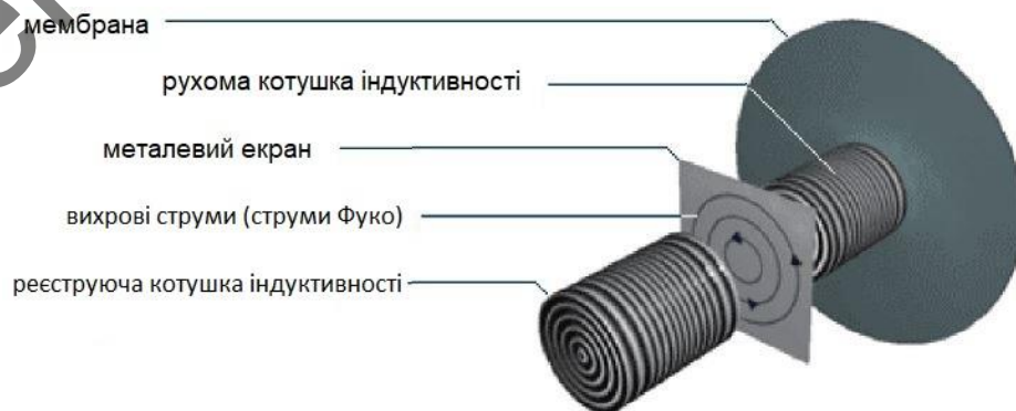
Рисунок 1.10 — Принципова схема індукційного перетворювача тиску
