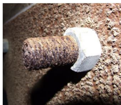
Типовий приклад контакту корозійних металевих предметів
