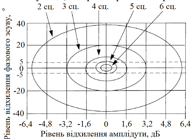
Рис.1. Фазові та амплітудні відхилення в залежності від розрядності
