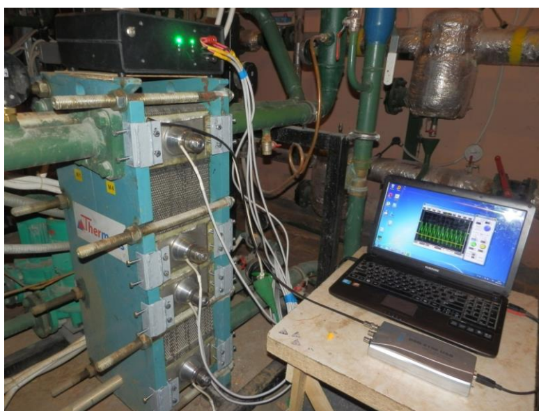
Дослідження впливу ультразвуку на фізико-хімічні процеси в пластинчастому теплообміннику
